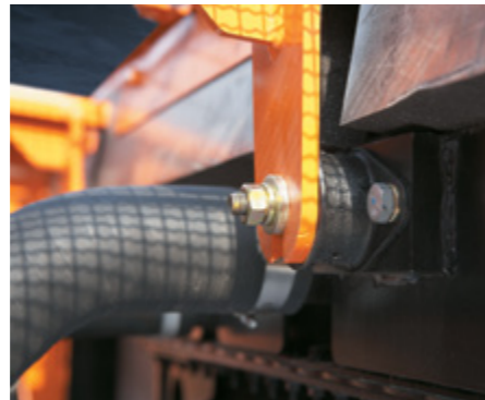
Soportes de caucho (para el radiador: 2 laterales y 2 verticales)
