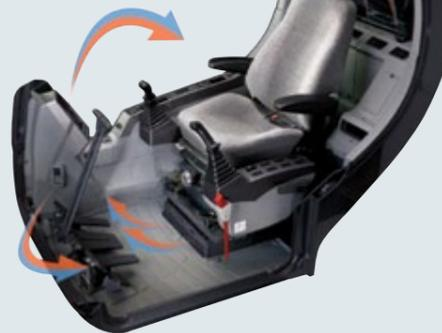
El aire acondicionado de alto rendimiento provee un caudal de aire que se ajusta y controla electrónicamente a las condiciones imperantes. Cinco modos de operación hacen que el operador más exigente pueda verse satisfecho.
