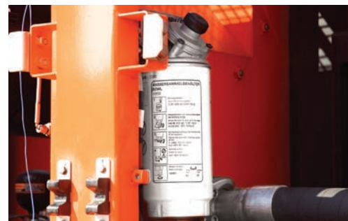
Prefiltro de combustible con separador de agua Mediante el uso de filtros múltiples se obtiene una alta eficacia en el filtrado del combustible. Lo anterior incluye un prefiltro de combustible que posee un separador de agua que elimina la humedad, las suciedades y las partículas extrañas del combustible. Para facilitar el mantenimiento, hemos instalado una válvula de purga de combustible.
