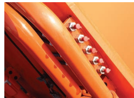
Puntos de engrase a distancia Para facilitar el mantenimiento, los puntos de engrase del brazo y la pluma se encuentran centralizados. La pluma y el brazo cuentan con puntos de engrase remotos y agrupados.
