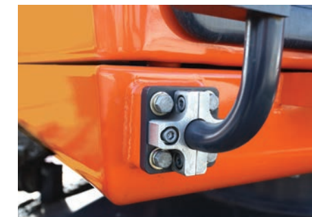
Nuevo pasamanos y baranda Los nuevos accesorios ahora están de acuerdo con las normas ISO 2867:2007. El acceso se ha visto facilitado y los accesorios han sido fuertemente reforzados.
