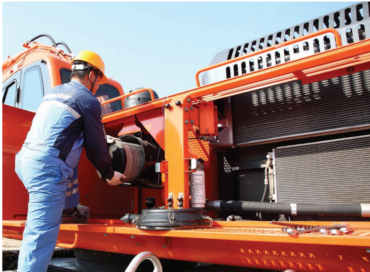
Piezas accesibles El acceso a los diversos radiadores es realmente fácil, lo que facilita su limpieza. Las partes del motor pueden alcanzarse sin problemas desde los paneles superior y lateral.
