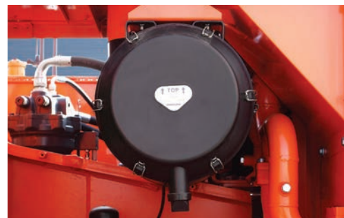
Filtro de aire con separador por filtración previa de polvo El depurador de aire forzado de gran capacidad elimina más del 99% de las partículas suspendidas en el aire. Lo anterior reduce el riesgo de contaminación del motor y aumenta el intervalo entre limpiezas y cambio de cartuchos. El sistema de prefiltro elimina el polvo mediante la fuerza centrífuga.
