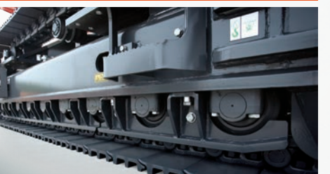
Protector del tren de orugas de tipo enterizo y componentes del chasis totalmente resistentes a los trabajos pesados
