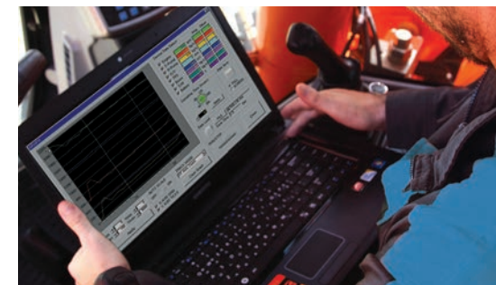
Monitoreo por PC Una función de monitoreo por PC permite conectarse al sistema e-EPOS. De esta manera, durante el mantenimiento es posible controlar varios parámetros, como las presiones de las bombas, la rotación del motor y la velocidad del motor. Estos datos pueden almacenarse e imprimirse para su posterior análisis.
