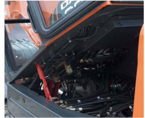
Cabina abatible para un fácil mantenimiento
