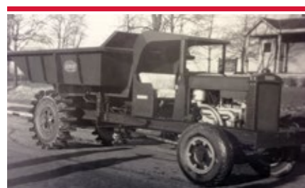
1934 El camión modelo 1Z - Considerado el primer camión de volteo fuera de carretera real
