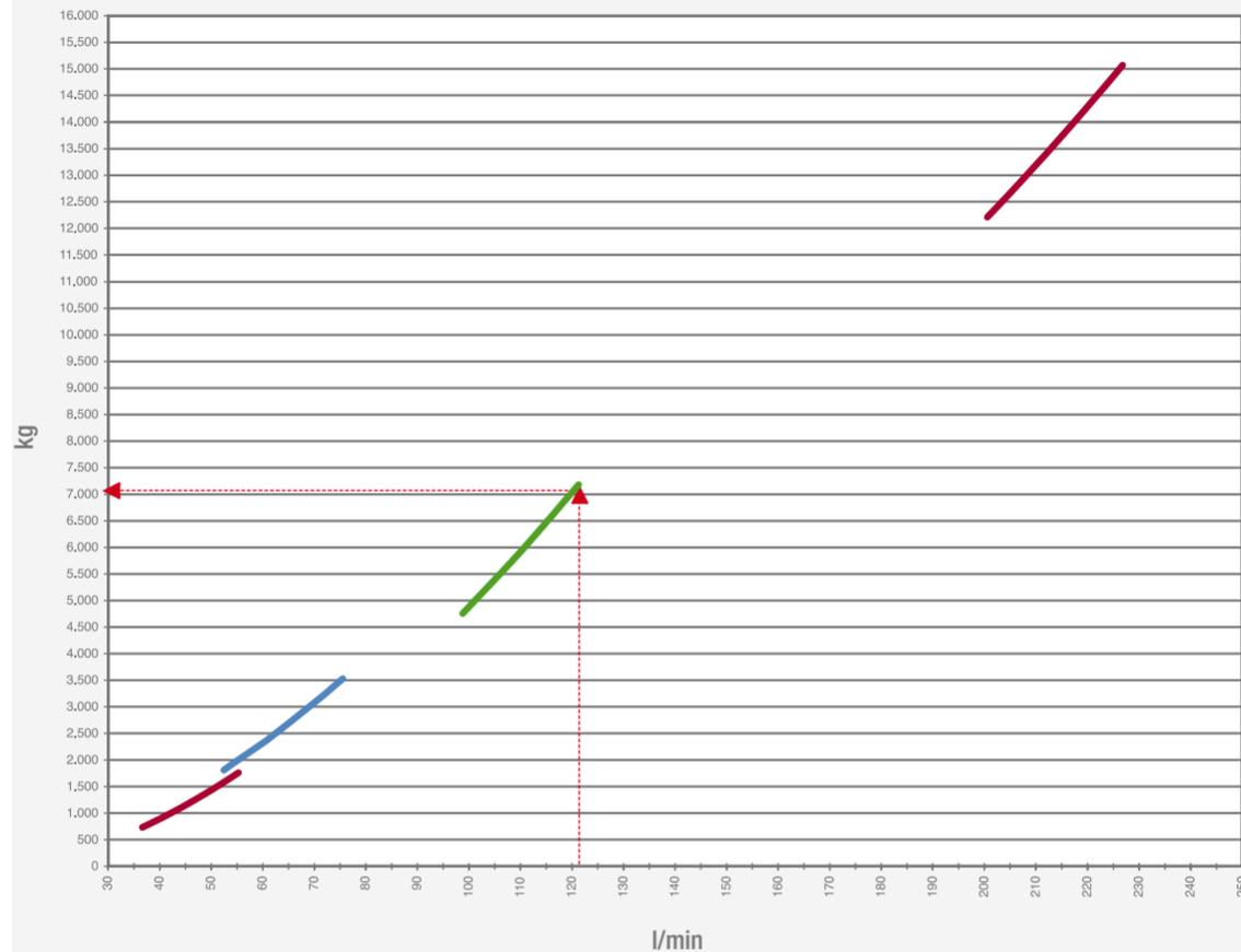
Ejemplo con un IHC 150: a un caudal de 120 l/min corresponde una fuerza centrífuga de 7.190 kg.
